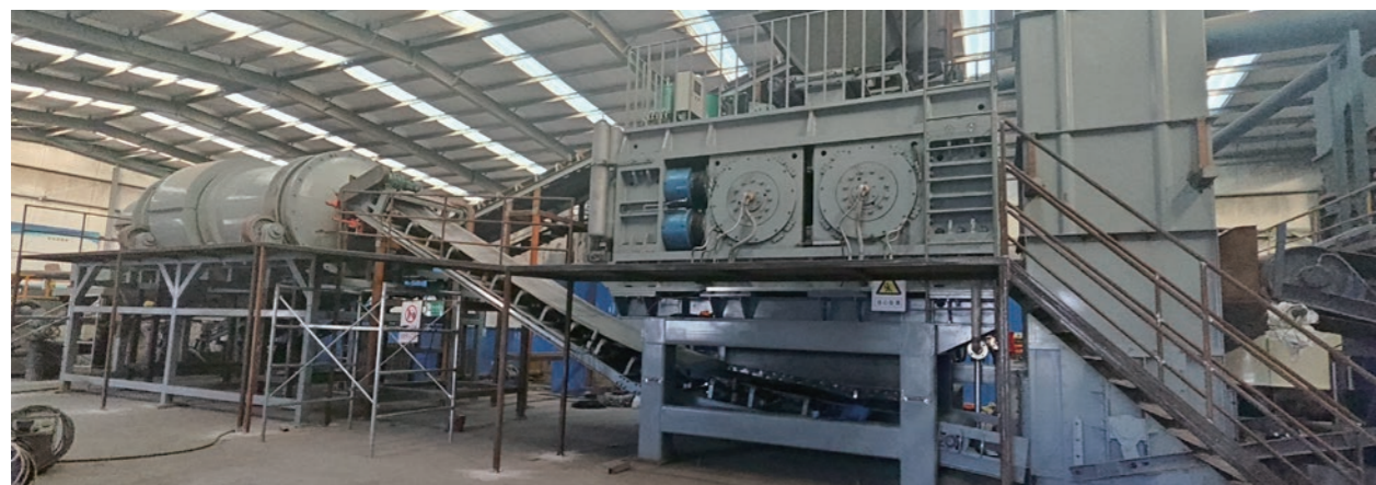
新型高压辊磨湿式制粉、选粉制浆一体化装备
